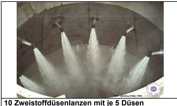
10 Zweistoffdüsenlanzen mit je 5 Düsen
