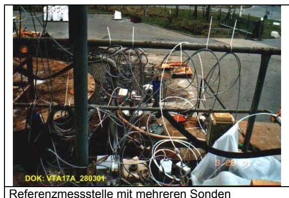
Referenzmessstelle mit mehreren Sonden
